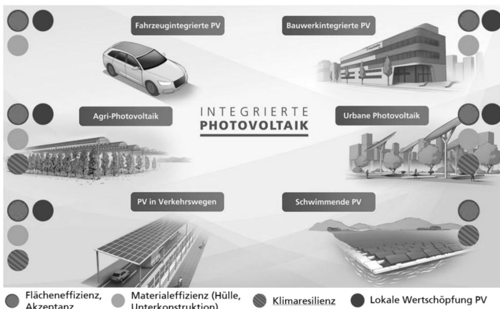
Technologien und Synergiepotenziale der Integrierten Photovoltaik (© Fraunhofer ISE)
